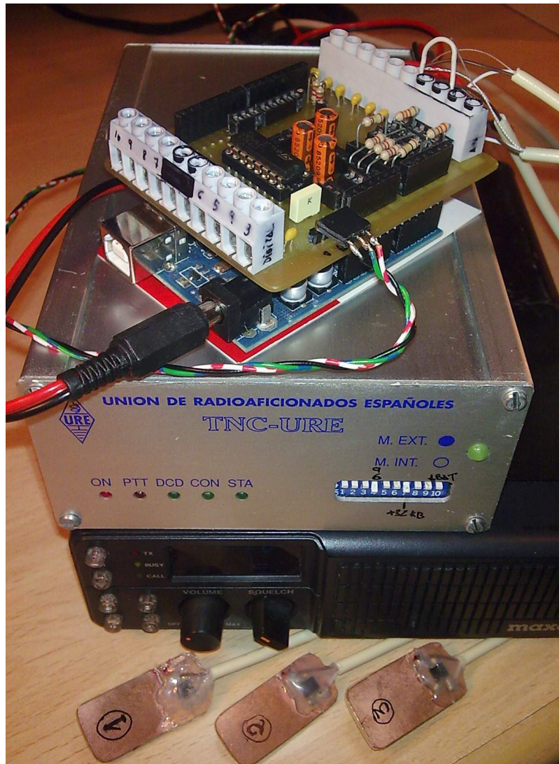
Figura 4: Digi de APRS ao que se lhe tem agregado um Telemetrino.
